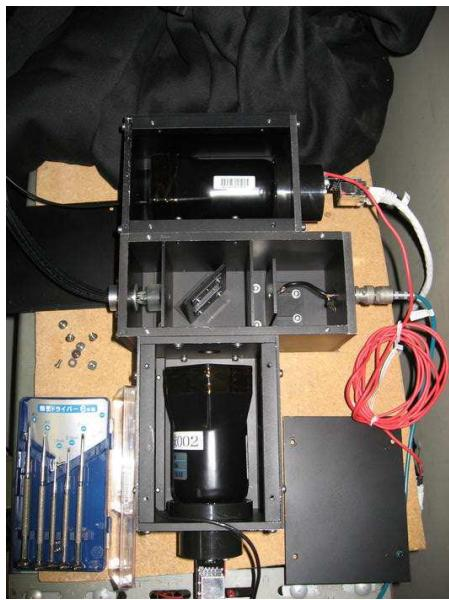
図 4.5: LED 光源とモニター用 PMT を収めた暗箱。箱内中央の区画にビームスプリッター (ハーフミラー) が見える。写真下が PMTch0。上が PMTch1 である。この箱は室温に置かれている。
