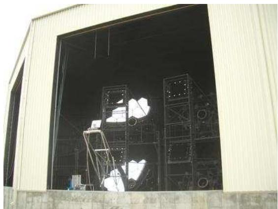
図 3.7: ステーション内に望遠鏡が設置された後、各セグメント鏡の方向を調整しているところ。
