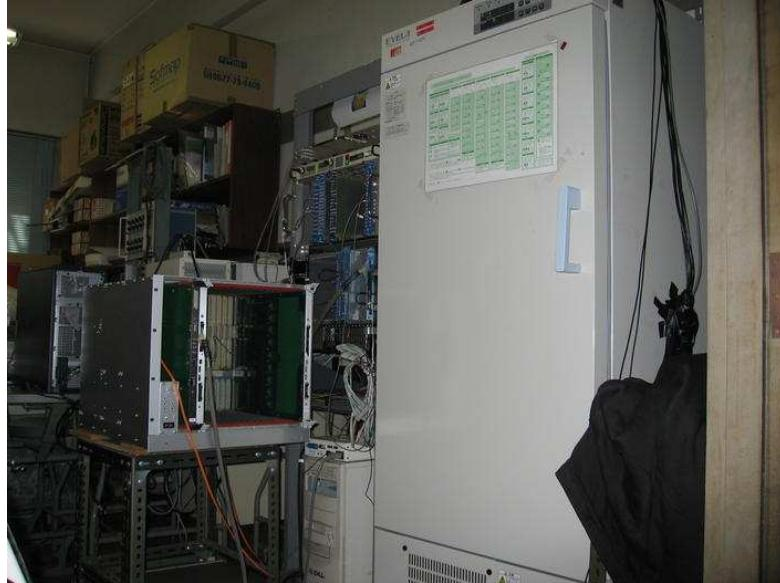
図 4.7: 写真右側は実験に使われた恒温槽の概観。左側の VME クレートに SDF ボードが挿入されている。
