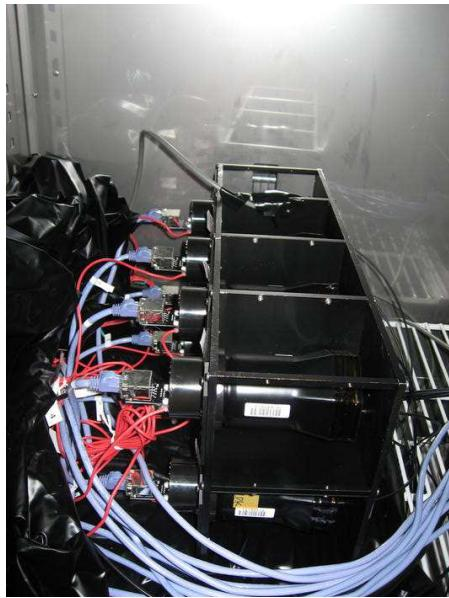
図 4.6: 被検査 PMT が取り付けられた。PMT ラック 4 列 2 段で 8 本の PMT が取り付けられている。これはインキュベータ内に置かれる。
