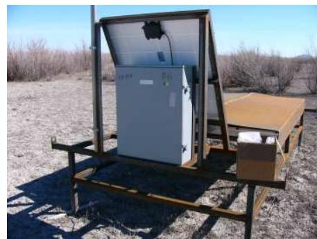
図 3.4: 地表検出器を背面から見た写真。ソーラーパネルの後ろにエレクトロニクスを収容している箱が取り付けられている。
