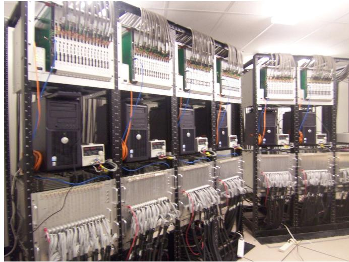
図 3.13: ステーションエレクトロニクス室内に設置されたデータ収集系と電源系。縦長のラック 1 台分が 1 カメラ分に相当する。最も上の VME クレートに SDF、TF があり、2 組目に VMEPC と プリアンプ用低電圧電源、3 段目に PMT 用高電圧電源が配置されている。
