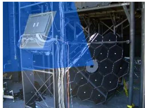
図 3.22: Xe flasher によるカメラゲイン較正の概念図。望遠鏡中心に取り付けられた Xe ランプが強度一様な光をカメラに照射する。
