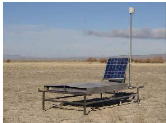
図 3.2: 現地に設置されたシンチレーション検出器
