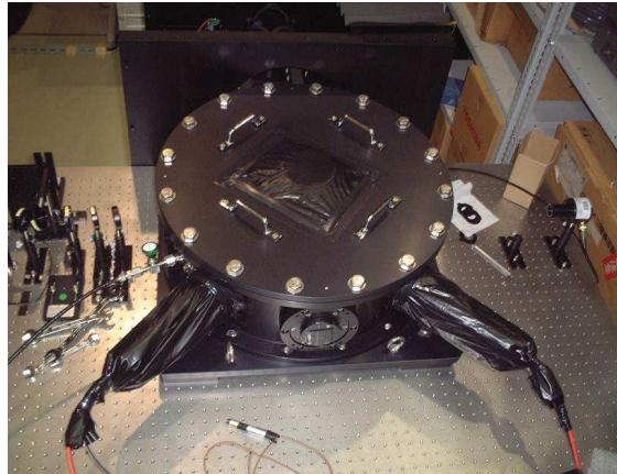
図 3.20: CRAYS。中心の円筒がチェンバーで被検査 PMT2 本が写真下側からチェンバーに挿入されている。レーザー光は写真左側から入射し、右側のエナジーメーターにあたる。
